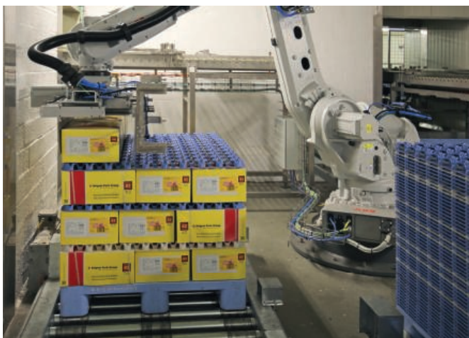
Optiflow spacers vriezen niet vast aan dozen en zijn eenvoudig te ontspaceren
