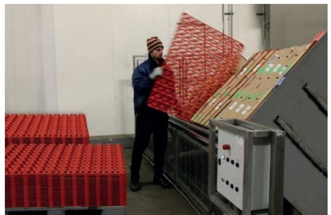
Optiflow spacers vriezen niet vast aan dozen en zijn eenvoudig te ontspaceren
